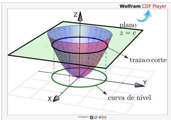
Figura 3.14: Trazo o corte  $z = c$  y curva de nivel.
