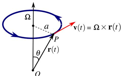
Figura 4.8: Rotación de  $P$  con velocidad angular  $\mathbf{v}(t) = \dot{\cdot} \times \mathbf{r}(t)$
