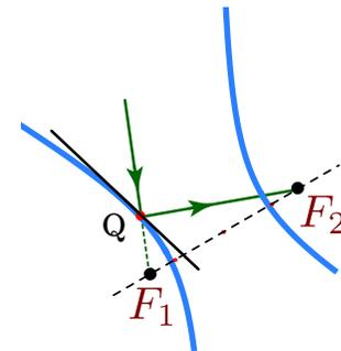
La propiedad focal de la hipérbola tiene varias aplicaciones. Por ejemplo, en la construcción de telescopios.
