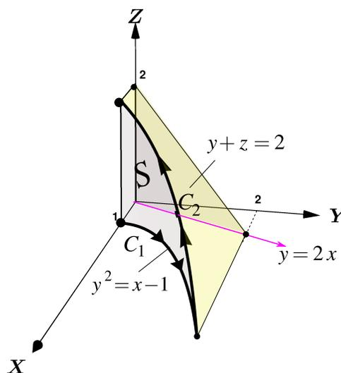
Figura 9.22: Curva  $C = C_1 + C_2$  y superficie  $S$
